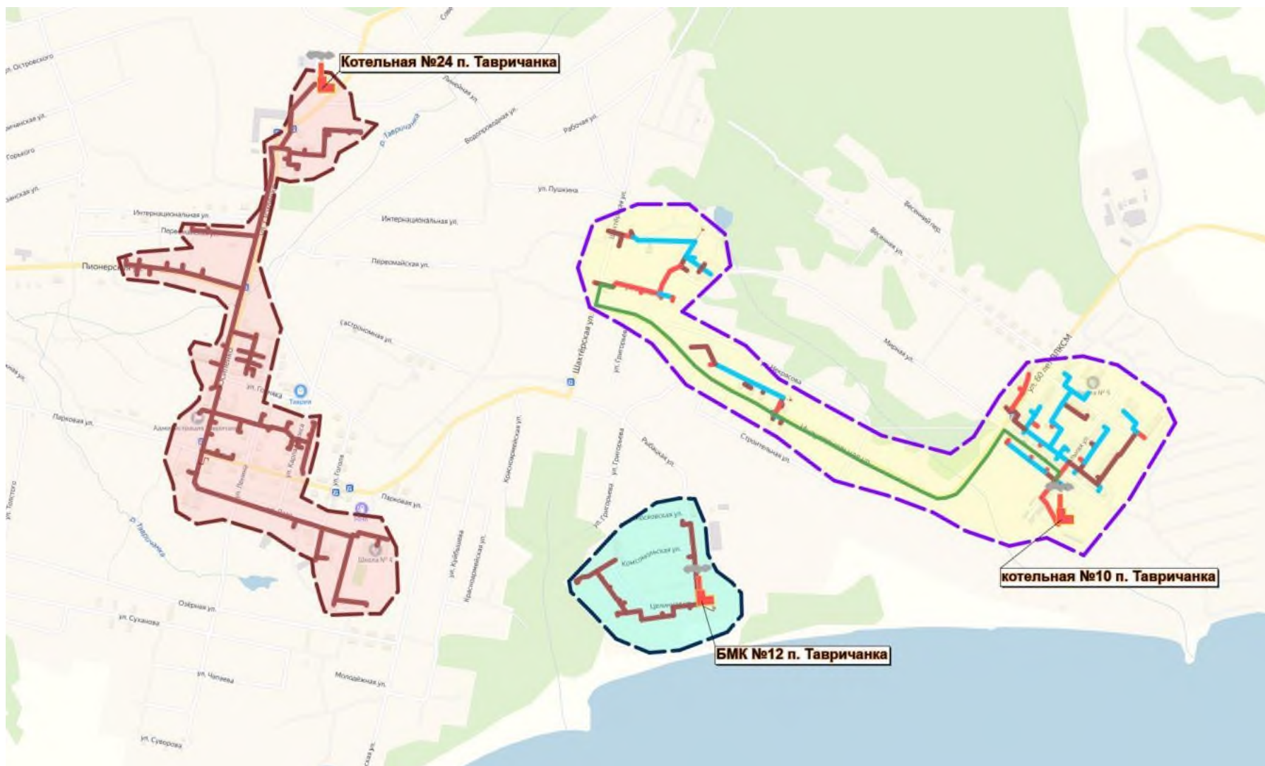
Рисунок 6.4-3 – Мероприятия по переводу нагрузки контуров котельных №11 и №25 в контур котельной №10 (перспективное положение)
