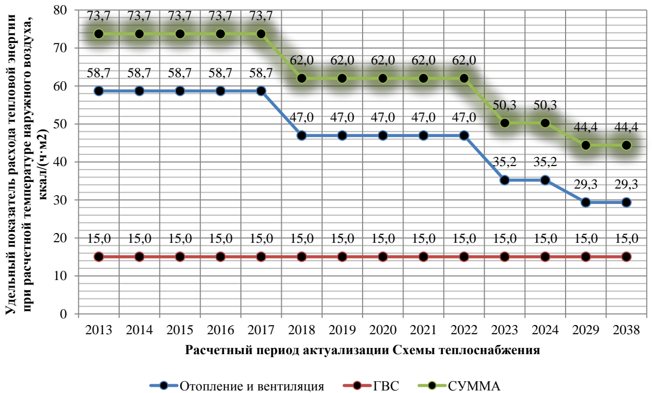
Рисунок 1-2 - Изменение нормируемого удельного расхода тепловой энергии на отопление, вентиляцию и ГВС на примере 5-этажного общественного здания
