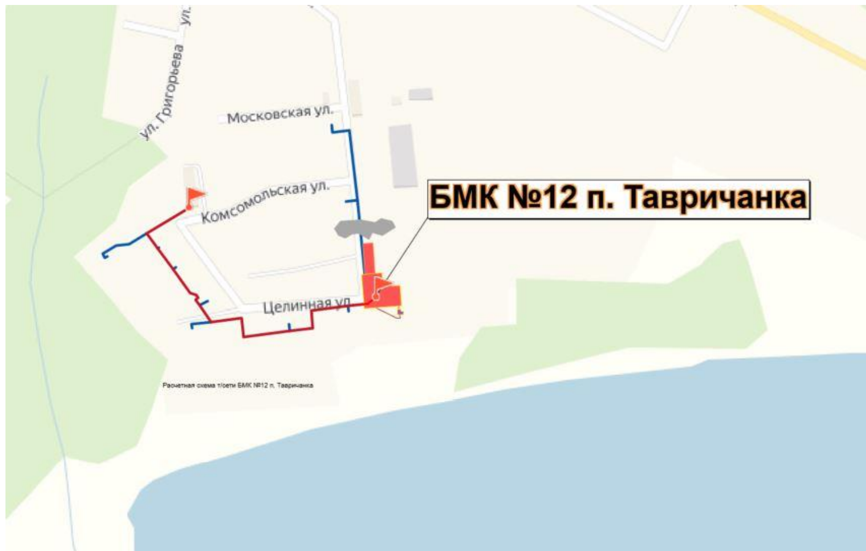
Рисунок 25 – Путь для построения пьезометрического графика участка котельной №12
