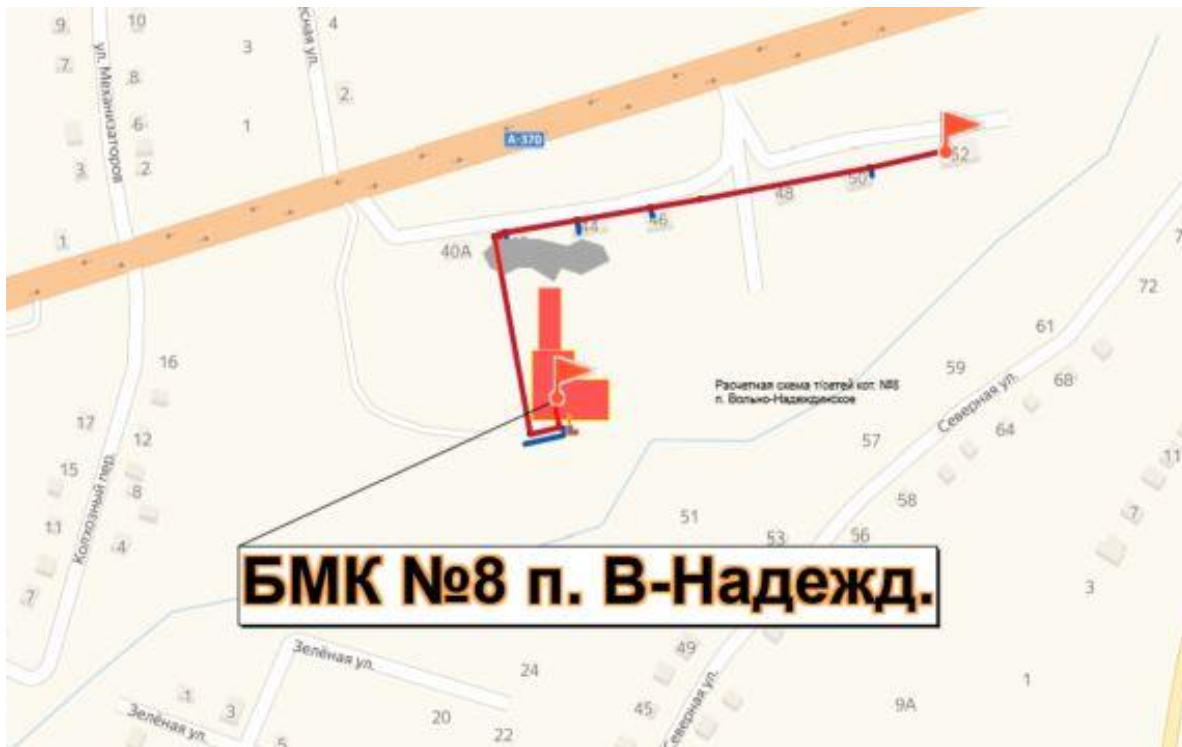
Рисунок 17 – Путь для построения пьезометрического графика участка котельной №8
