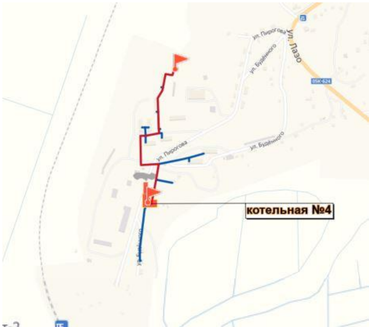
Рисунок 9 – Путь для построения пьезометрического графика участка котельной №4
