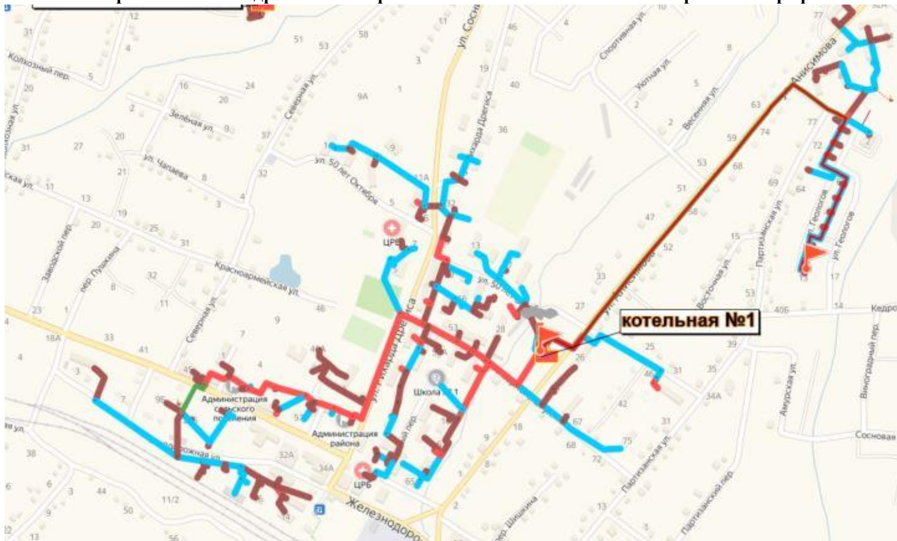
Рисунок 63 – Путь для построения пьезометрического графика участка котельной №1
