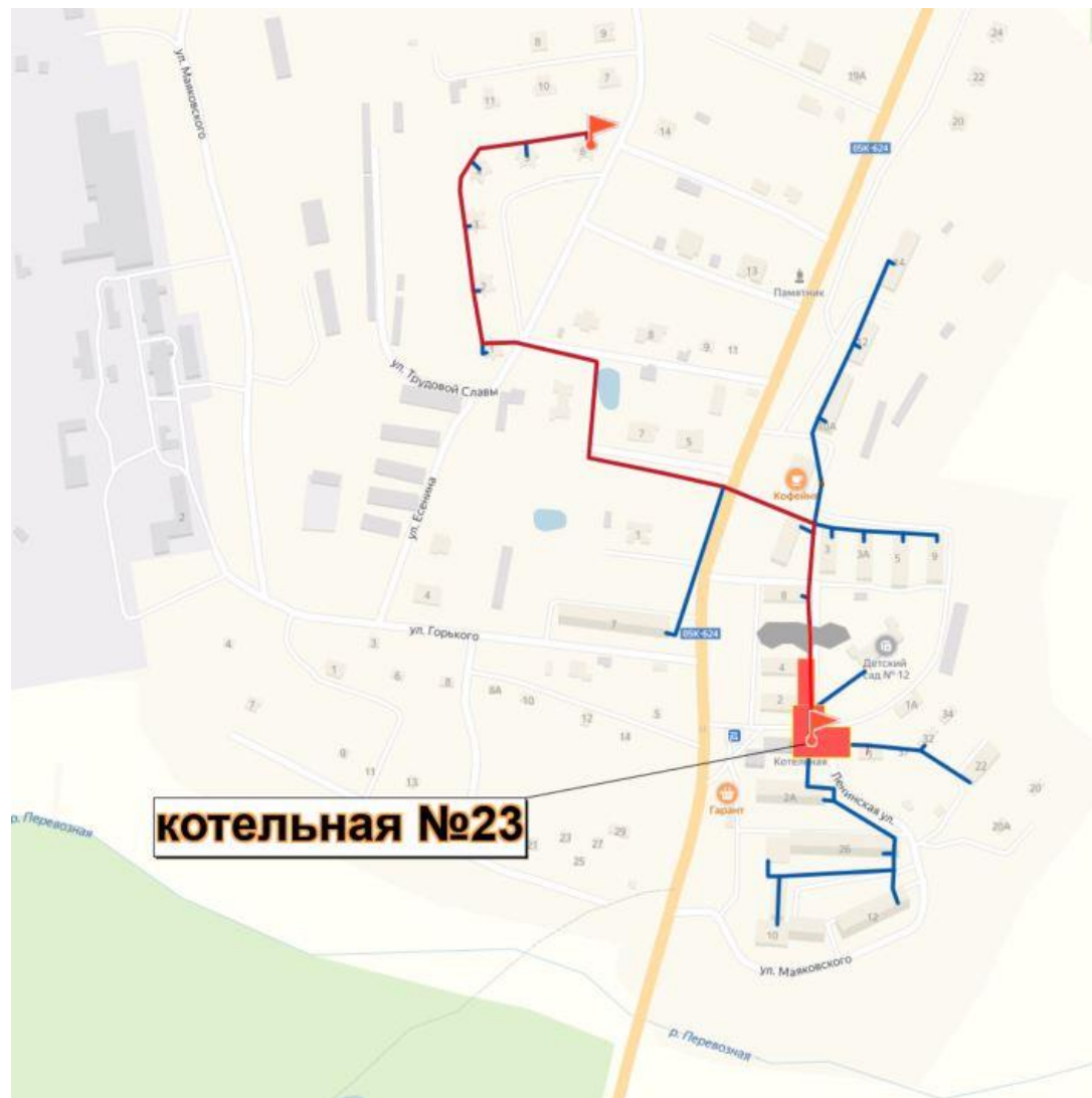
Рисунок 41 – Путь для построения пьезометрического графика участка котельной №23
