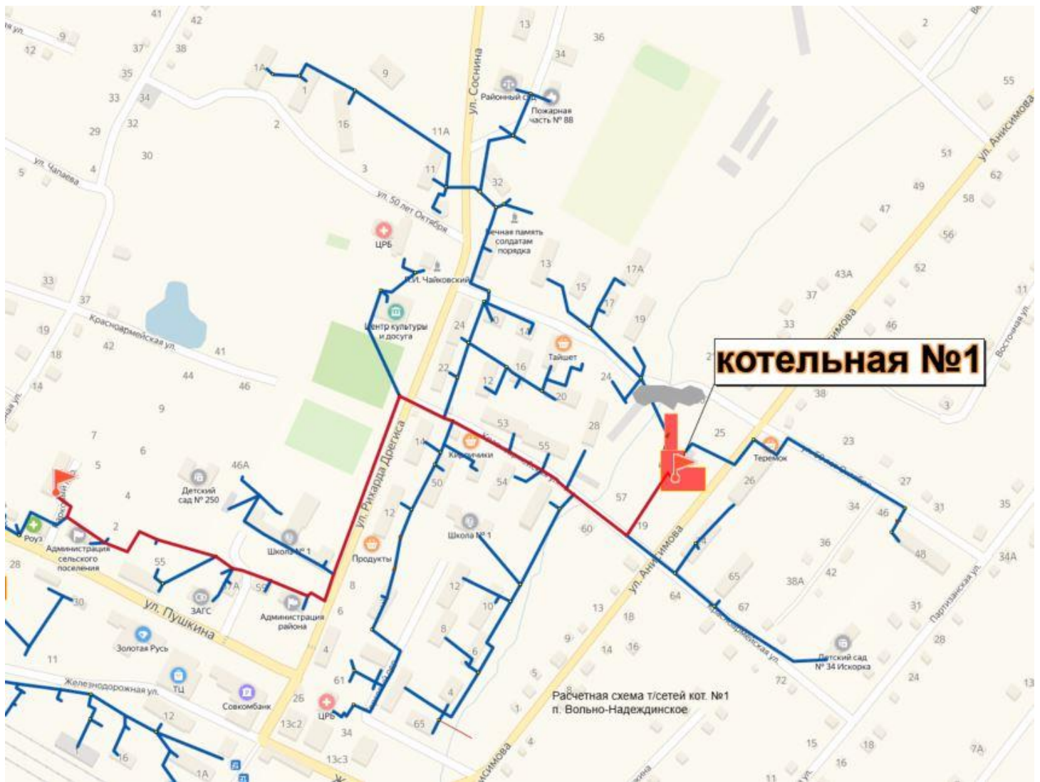
Рисунок 3 – Путь для построения пьезометрического графика участка котельной №1
