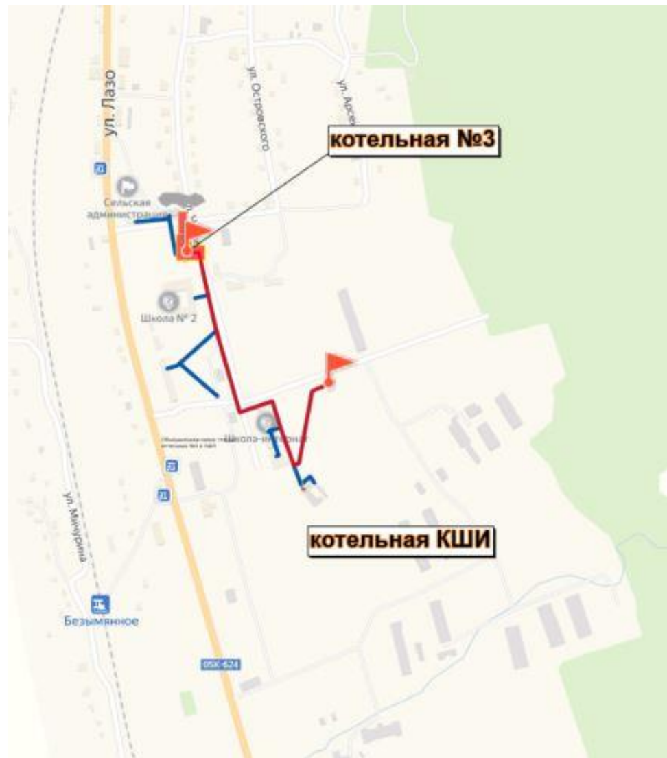
Рисунок 7 – Путь для построения пьезометрического графика участка котельной №3
