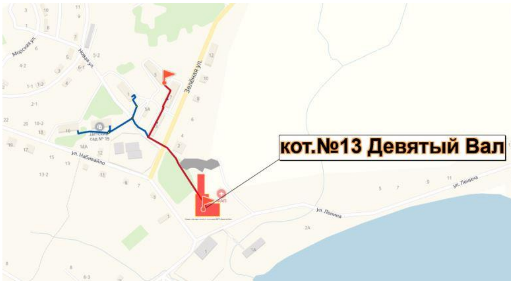
Рисунок 1 – Путь для построения пьезометрического графика участка котельной №13
