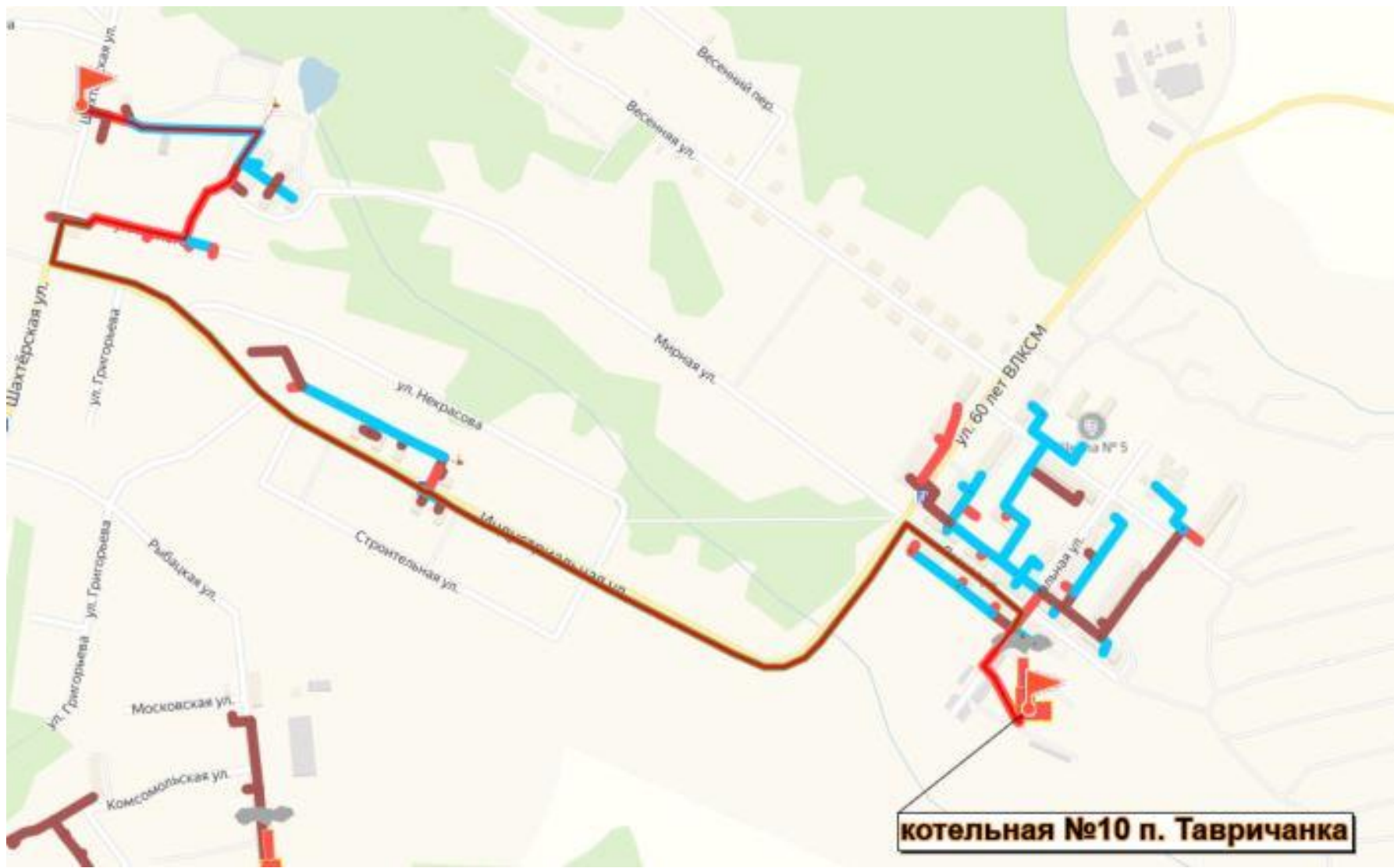
Рисунок 65 – Путь для построения пьезометрического графика участка котельной №10
